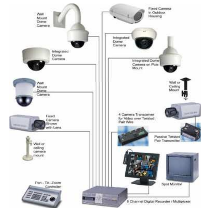
Figura I.2.83. Arquitectura del sistema de CCTV.
