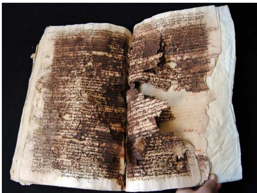
Figura II.1.2 Fragmentación y perforación del papel producida por tintas metaloácidas en Ms45, antes de ser intervenido.
