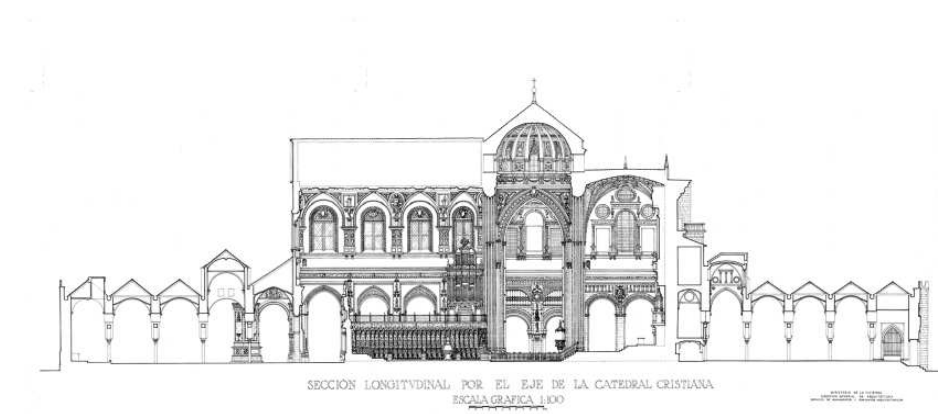
Figura I.2.25. Dirección General de Arquitectura (1972). Córdoba, Mezquita y Catedral Cristiana. Sección longitudinal por el eje de la Catedral Cristiana, escala 1:100. IPCE, Planoteca, 19416.
